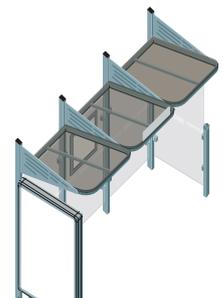
Longueur 3000 avec 1 caisson lumineux à gauche et 1 vitrage à droite
