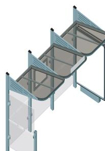
Longueur 3000 avec 1 caisson lumineux à droite et 1 vitrage à gauche
