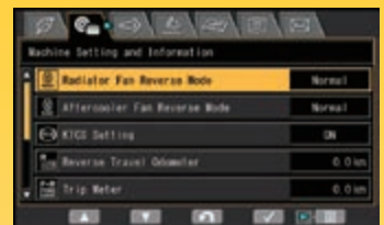
Mode du ventilateur de refroidissement
