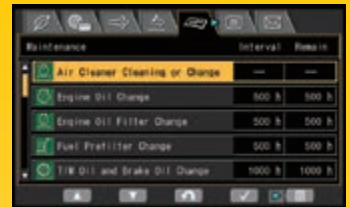
Écran de base de maintenance
