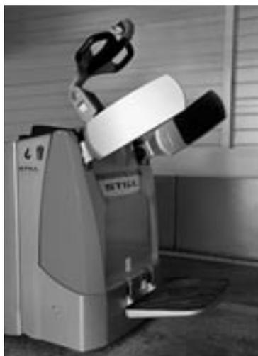
Protections latérales réglables en hauteur et timon ergonomique conçu pour une conduite optimale.
