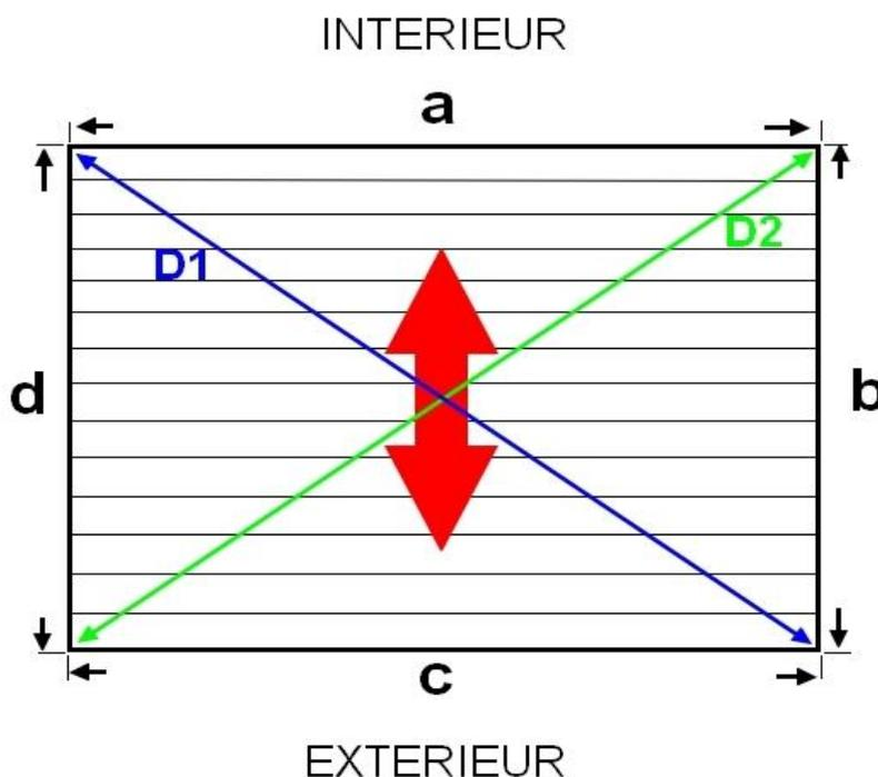
*Les relevés D1 et D2 sont préconisés dans le cas d'une fosse existante avant la commande du tapis. Une réservation peut être non totalement rectangulaire. Les relevés D1 et D2 permettront, dans ce cas d'adapter parfaitement les dimensions du tapis.*
