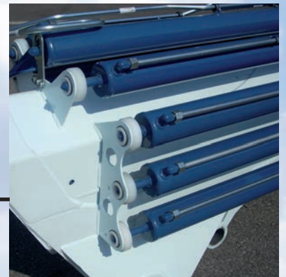
Sistema blocco cilindri gru chiusa Cylinders locking system when crane is folded Système de retenue vérin a grue ferme Halterung System mit zusammengelegten Kran
