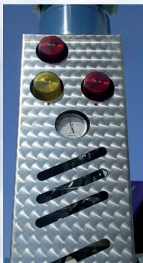
Manometro e flash indicatori dello stato di carico della gru Pressure gauge and flashing light indicating the load condition Indicateur de pression et signal lumineux, indiquant l'état de charge Manometer und optische Überlastanzeige
