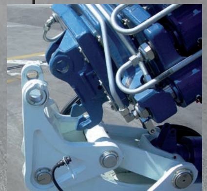
Aggancio/Sgancio rapido JIB Quick connection and disconnection of the JIB Connexion rapide de JIB Schnellkupplung des Jib (für die Hydraulik: hydraulische Schnellkupplung)
