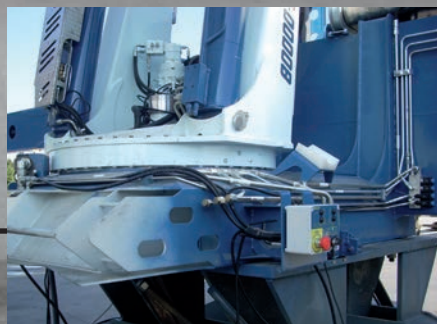
Telaio scatolato integrale Integrated sub frame Faux châssis intégral Integrierter Hilfsrahmen
