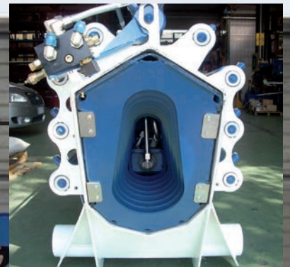
10 a e 11 a prolunga idraulica con cilindro interno 10 th and 11 th hydraulic extension with intern cylinder 10 ème et 11 ème extension hydraulique avec cylindre interne Die 10 und 11 hydraulische erlänge rung ist mit ein nternen Zylinder gesteuert
