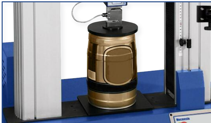
Test de compression verticale utilisant un plateau de compression circulaire
