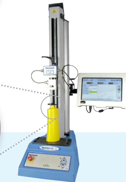
Test de RCV sur bouteille PET utilisant un banc d'essai MultiTest 2.5-xt
