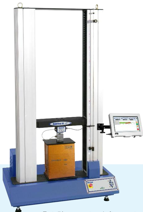
Test d'écrasement sur boîte en carton utilisant un banc d'essai MultiTest 10-i
