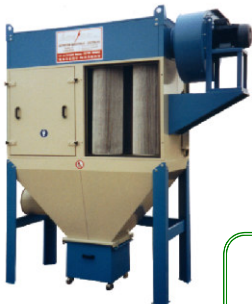
Cartouches filtrantes Ø 325 mm, H = 1000 mm, Ventilateur d'aspiration non compris.
