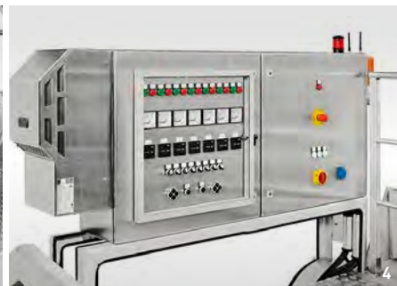
4 Grâce au groupe de refroidissement intégré, l'armoire électrique est conçue même pour les températures ambiantes les plus chaudes. En cas d'urgence, le racleur de boue de fond peut être également commandé directement via l'unité de commutation protégée contre les explosions.
