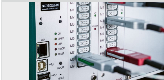
Connexions des capteurs ALMEMO® et pour la mise en réseau (témoin d'état OLED)
