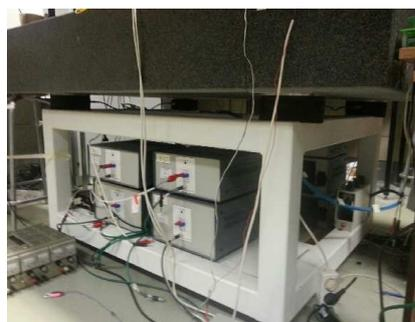
Construction Plateau marbre granit épaisseur 70 mm posé sur 4 coussins d air basse fréquence ISOLAIR Structure en acier mécano-soudé très rigide 80x80 revêtu peinture époxy blanc
