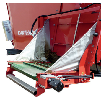
Trappe de distribution latérale avec tapis inclinable en PVC (1000mm).
