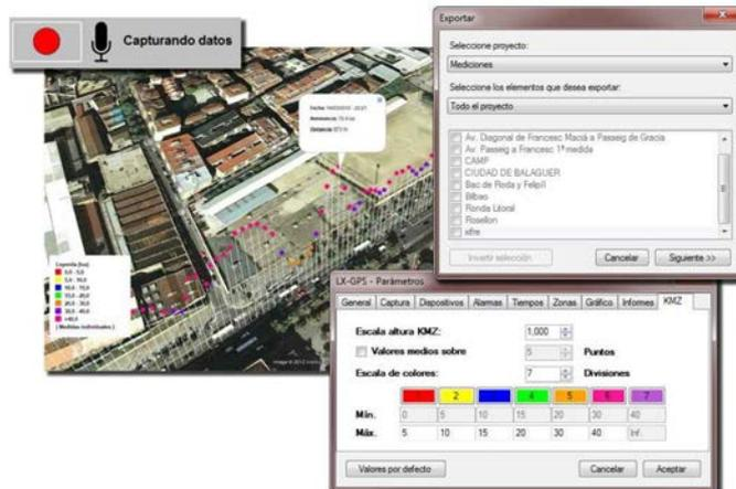
Création de fichiers KMZ des mesures, qui incluent un code de couleur, en fonction d'une échelle de niveau de hauteur proportionnel et configurable par rapport à la valeur mesurée, dans le but de reproduire et d'afficher dans Google Earth des mesures 3D effectuées dans votre environnement
