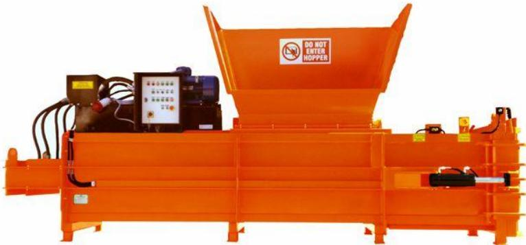
La CK450HFE ci-dessus est montée d'un vérin hydraulique et d'une trémie évasée 2.2m.
