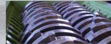
Les lames de cisaillement pour déchetage grossier / à grandes dents (35 mm) sont utilisées pour le broyage grossier, où la capacité peut être augmentée (jusqu'à un maximum d'environ 6000 kg/h) en modifiant l'angle d'orientation des lames de cisaillement. Cela augmente l'adhérence sur le matériau à broyer.
