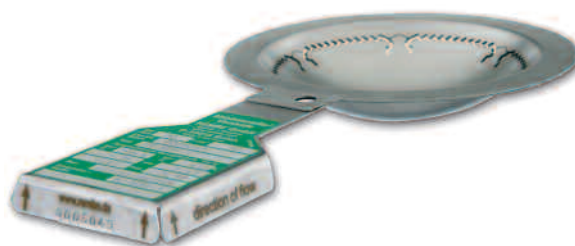
la pression d'éclatement est définie par une calotte à pattes de flambage séparée du fluide process
