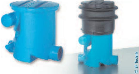
Pré-filtre pouvant être enterré ou placé dans un local technique. Son principe de fonctionnement comprend un nettoyage en deux étapes avec une séparation des salissures grossières et une filtration des particules de plus de 0,50 mm de diamètre.
