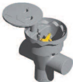
Prise d'eau à enterrer comprenant deux vannes en laiton avec connexions automatiques. Le raccordement à la pompe immergée de la cuve est possible latéralement ou par la base. Boîtier et couvercle en PEHD.
