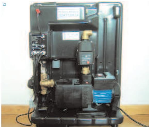
La pompe McRain permet d'exploiter l'eau de pluie à partir d'un réservoir et permute automatiquement sur le réseau d'eau potable lorsque la citerne est vide. Elle garantit la disconnexion obligatoire entre le réseau d'eau potable et le réseau d'eau de pluie (NF EN 1717).
