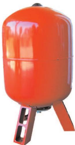
Le réservoir à vessie se place en sortie de pompe afin de compenser la perte de pression causée par l'ouverture d'un robinet. Il évite ainsi un démarrage trop fréquent de la pompe.
