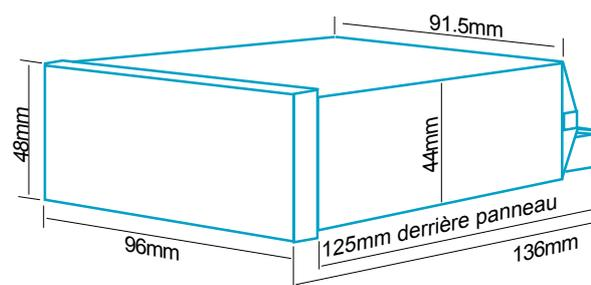
La découpe panneau doit être : 92mm de large x 45mm de haut, 1 mm,-0mm 1 / 8 DIN. Profondeur derrière panneau 125mm max, y compris les câbles. Poids typique de 350 g.
