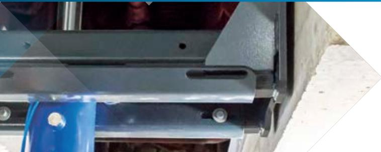
La largeur du châssis du vérin de fosse suspendu est réglable, il peut donc être utilisé de façon universelle sur toute fosse de travail sans qu'il soit nécessaire d'en modifier les profils en U
