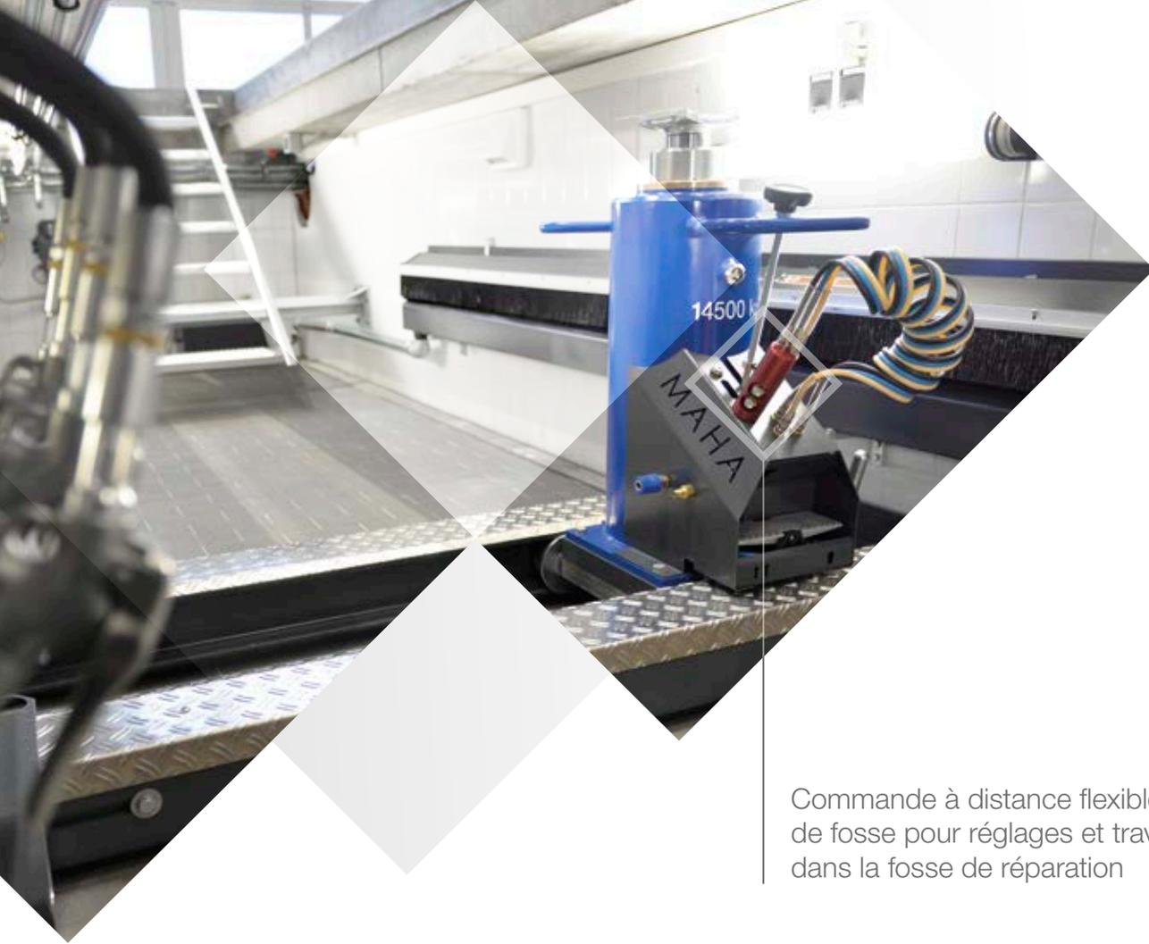
Commande à distance flexible du vérin de fosse pour réglages et travaux latéraux dans la fosse de réparation
