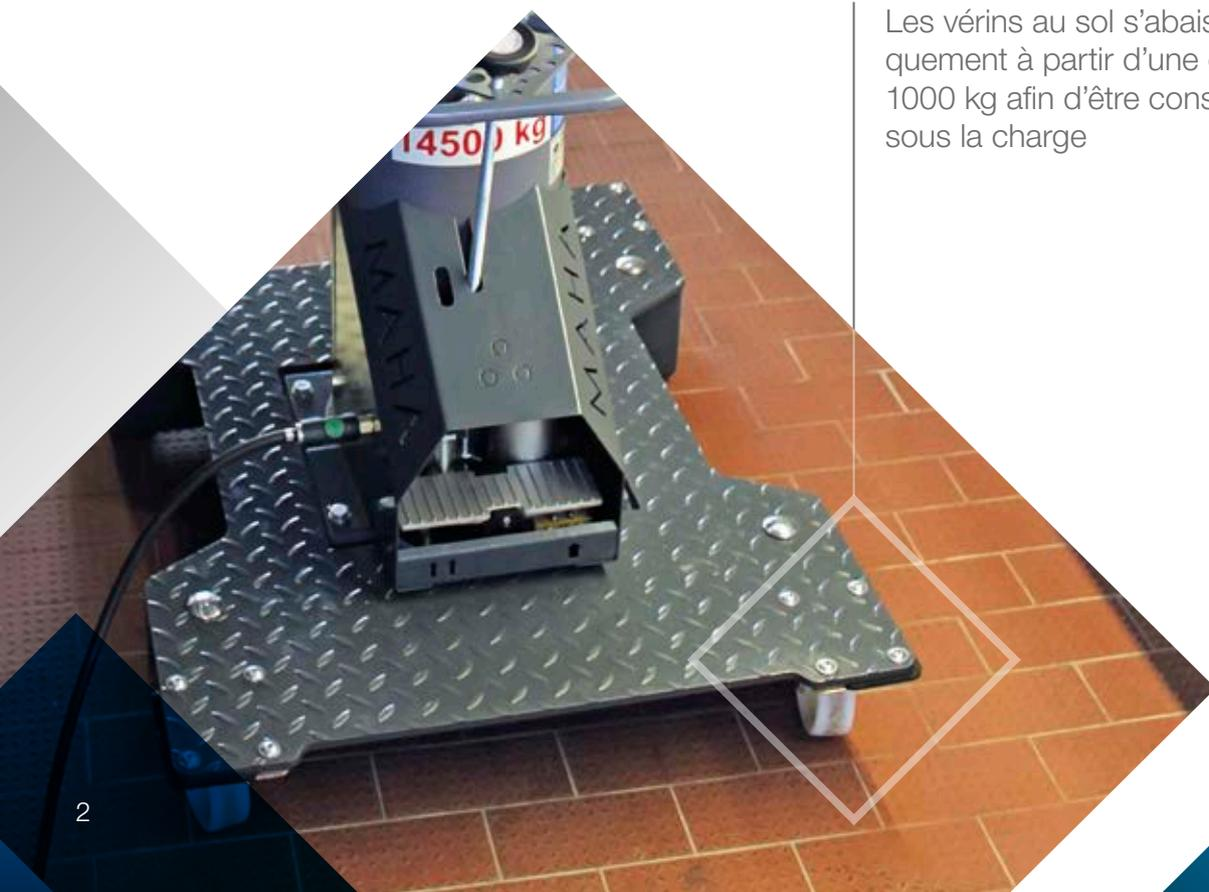
Les vérins au sol s'abaissent automatiquement à partir d'une charge d'environ 1000 kg afin d'être constamment sécurisés sous la charge
