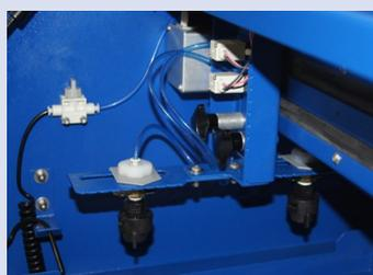
Sélection des buses droite et/ou gauche, pour une plus grande précision de diffusion et une économie de liquide de prétraitement.
