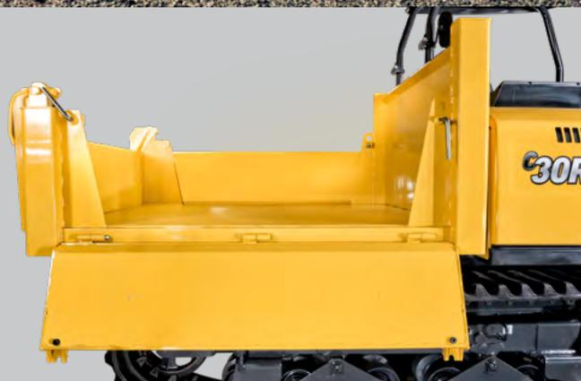
Benne à trois côtés avec déversement par l'arrière
