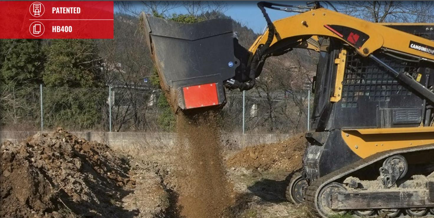
ADAPTÉ À LA SÉLECTION DE DÉCHETS DE TRAVAUX DE DÉMOLITION, CONCASSAGE OU TERRASSEMENT, ET AU MALAXAGE DE TERRE ET TOURBE GRÂCE AU CRIBLEUR HYDRAULIQUE DOTÉ DE COUTEAUX ROTATIFS EN HB400. EN CONFIGURATION STANDARD, LA TAILLE DU MATÉRIAU PEUT ÊTRE COMPRISE ENTRE 0 ET 20 ET ENTRE 0 ET 35. LES DIMENSIONS DES ARBRES PEUVENT ÊTRE VARIÉES SELON LES EXIGENCES.
