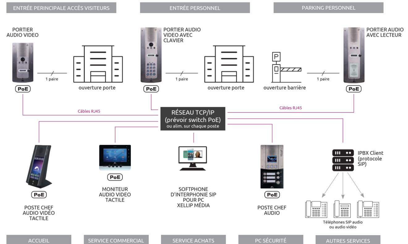
Câblage RJ45 catégorie 5 ou 6. Câblage commande ouverture SYT1 9/10<sup>ème</sup>.
