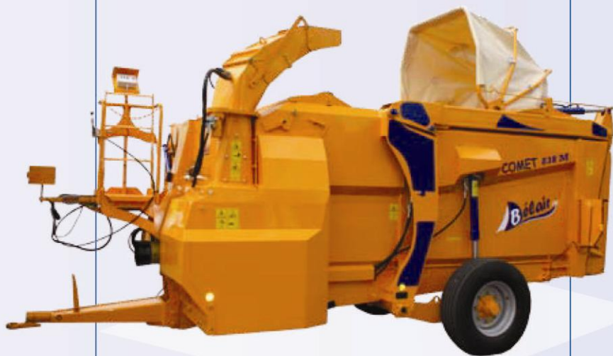
COMET 838 M - Désileuse mélangeuse pailleuse Goulotte standard et goulotte de mélange fixe
