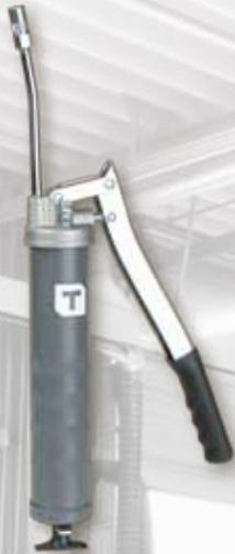
Pompe à graisse industrielle stable et robuste livrée avec un tube rigide de 150 mm et une agrafe hydraulique. Livrée dans un carton serigraphié.
