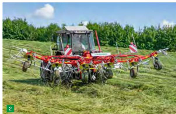
Pour permettre sur les fourrières un relèvement suffisant des dents par rapport au sol même avec des petits tracteurs, les faneuses portées 6 toupies HIT peuvent être équipées en option de deux dispositifs.
