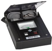
Matériel compact et pratique (mallette de transport incluse), au fonctionnement facile, pour une vérification du taux d'humidité instantanée.
