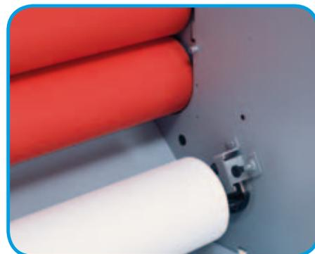
Capteur magnétique de table. Si la table d'introduction n'est pas en place, l'avance des rouleaux est bloquée.
