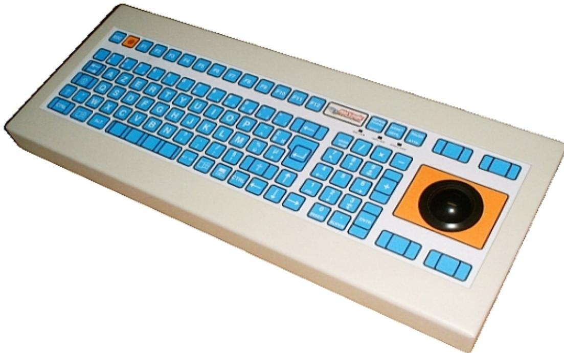
*Le clavier E99TB-T remplace les claviers PC standards dans les applications où un haut niveau de protection est exigé.*
