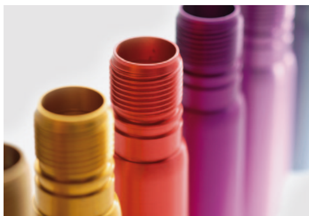
Contrôle qualité afin d'éviter des différences de couleur lors de l'anodisation de l'aluminium
