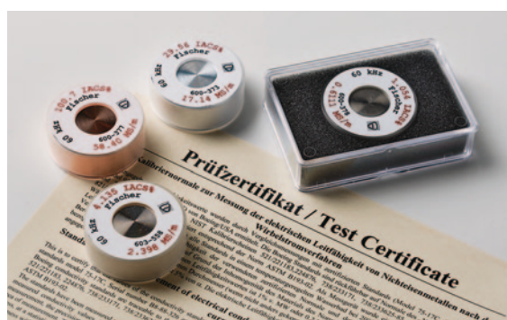
Étalons certifiés pour l'étalonnage du SIGMASCOPE® SMP350, traçables suivant les normes internationalement reconnues
