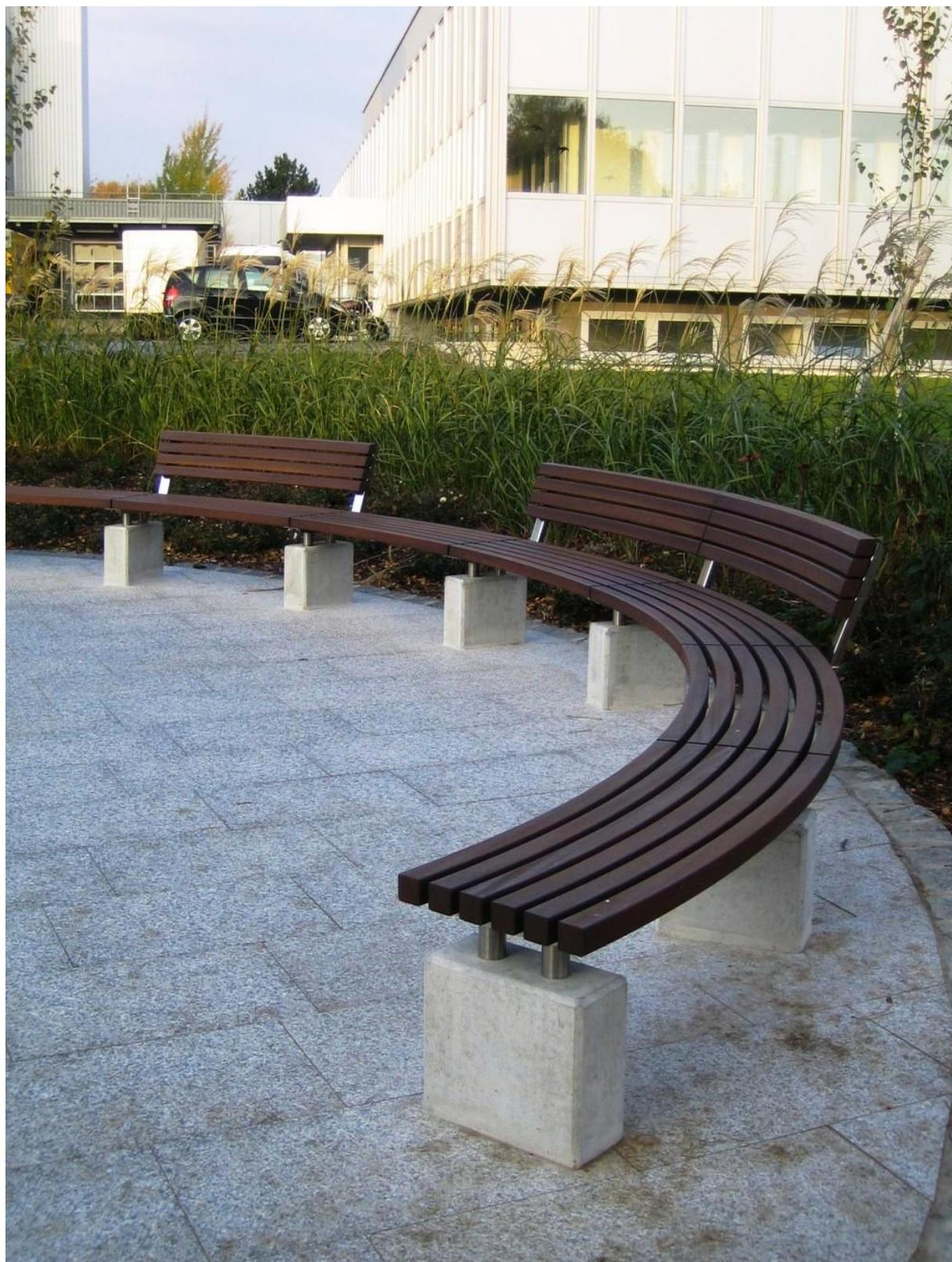
**Banc d'extérieur GOZO (avec ou sans dossier) esthétique avec piétements en béton H.P. teinté gris ciment, chanfreinés, et assise composée de 6 lames de bois exotique option éco-certification label FSC, lasure au choix, section 50 x 50 mm.**
