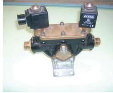
Vannes à clapet
