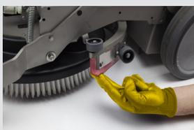
2. Vérifier le bon état des lames du suceur et, si nécessaire, les tourner ou les remplacer
