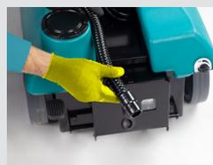
4. Enlever le bouchon de fermeture et vider le réservoir de récupération
