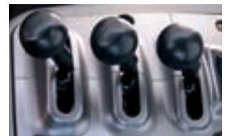
Mini-leviers servocommandés Trois leviers pour commander les bras de levage, le godet et le circuit hydraulique auxiliaire. Contacteurs pour AV/PM/AR, rétrogradage forcé, retour en position d'attaque, arrêt automatique des bras de levage et mode de flottement.
