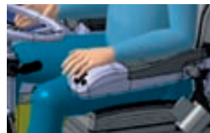
Direction électrique Pour des cycles de travail rapides et sans effort, la direction peut s'effectuer à l'aide d'un contacteur servo-électrique. Deux modes de direction : un mode pour les trajets sur longues distances, un mode pour une maniabilité accrue dans les espaces exigus. La direction électrique permet de reprendre le contrôle à tout moment avec la direction conventionnelle.
