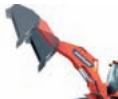
Bras de levage à grande hauteur Plus de portée de déversement et plus de hauteur au pivot de godet
