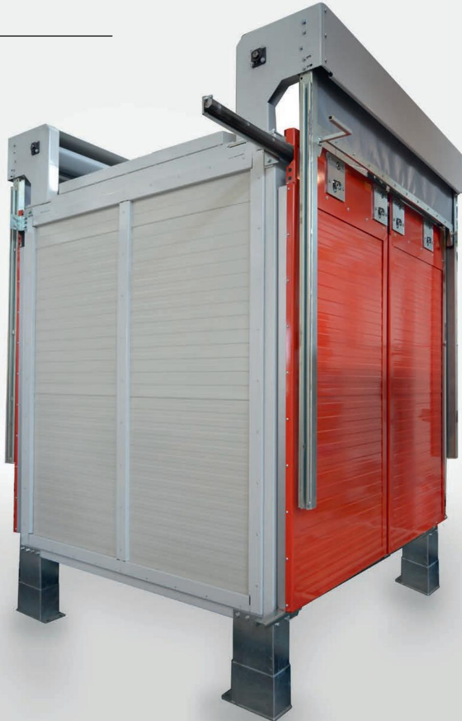
**Il forno a camera FMC - disponibile in due versioni, a gas o elettrico - è concepito per una produzione di 60-70 pacchi/ora.**
