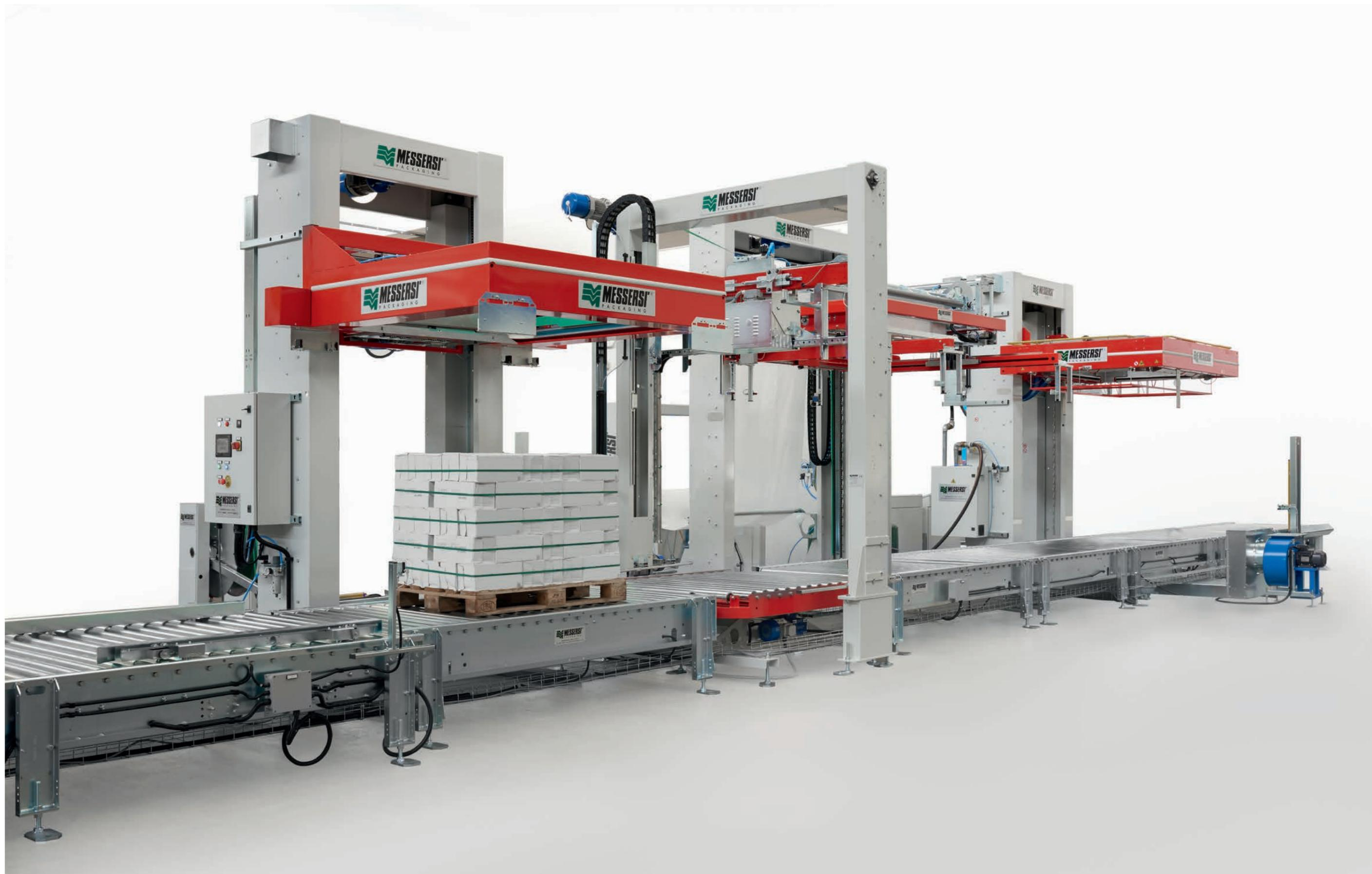
Linea di imballaggio per il settore laterizi: macchina incappucciante combinata SH51
