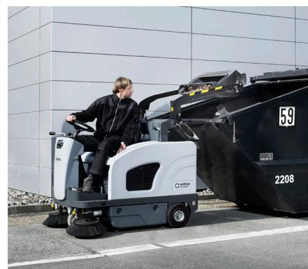
La trémie rétractable peut être fermée à partir du poste de pilotage, ce qui permet à l'opérateur de repartir immédiatement après avoir déversé les déchets dans un conteneur
