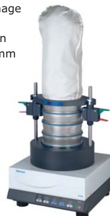
Le TG 200 pour le séchage de tamis d'analyse
