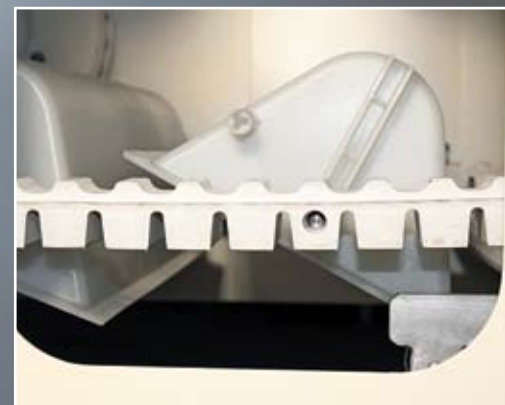
Die Entleerung wird an der Kippstation ausgelöst.
