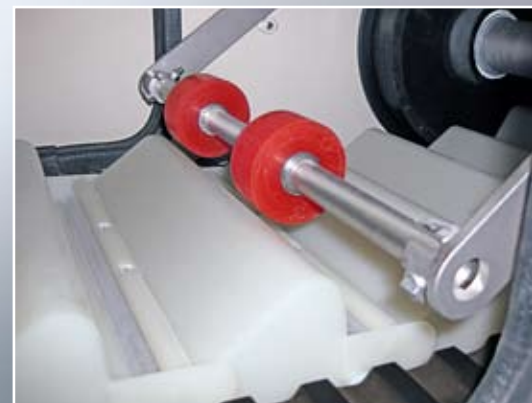
Pendelklopper zur Unterstützung des Produktauswurfs
