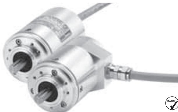
Le codeur absolu multitours Sendix 7068 avec interface Profibus et capteurs optiques offre la protection Ex dans un boîtier compact et robuste de 70 millimètres en aluminium résistant à l'eau de mer.
