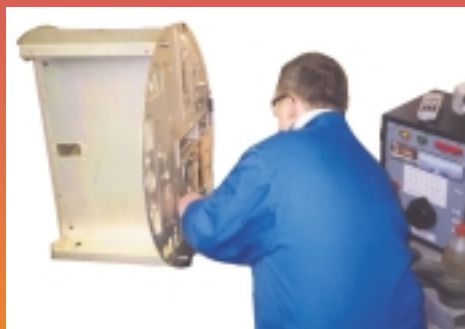
Réparation de l'étamage sur aluminium sur structure radar Mirage 2000
