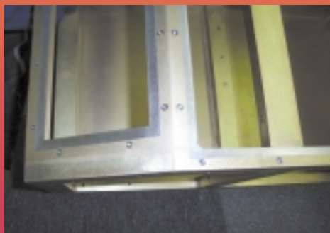
Etamage sélectif sur baie électronique pour protection CEM
