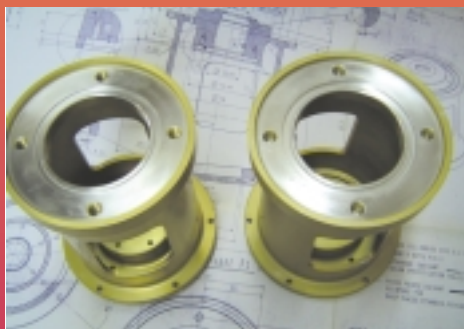
Etamage sélectif sur composant de radar
