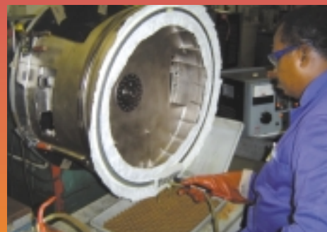
Dépôt sélectif d'étain pour continuité électrique et couplage galvanique sur stucture radar Rafale
