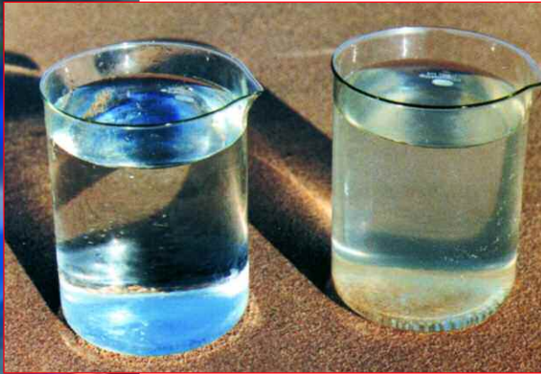
A gauche, eau de mer pompée sous la plage à droite eau de mer pompée en surface
