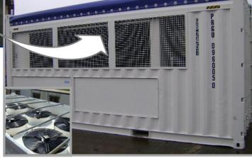
La containerisation est la solution optimale pour un groupe froid mobile
