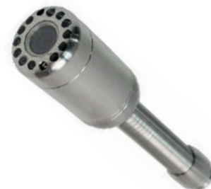
Ressort extra long (210mm) DN+ Camera Ø28 x 52mm sonde 512Hz intégrée fonction fil d'eau
