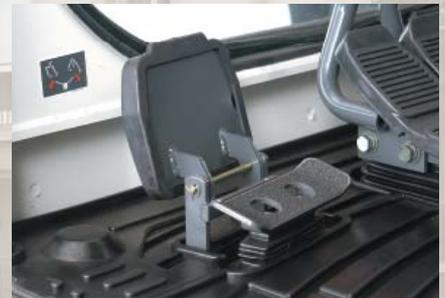
*Appuyer sur la pédale à gauche ou à droite pour étendre ou rétracter la flèche.*
