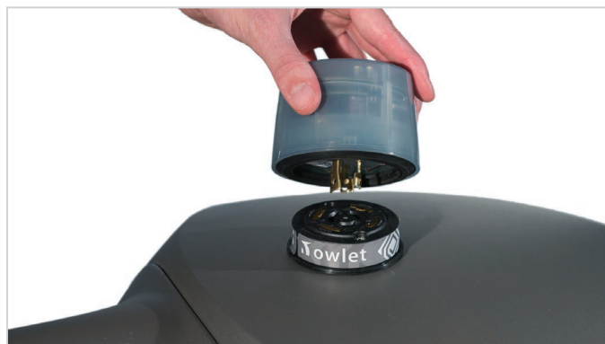
Branchement du contrôleur LUCO P7 CM sur la prise NEMA à 7 broches.
