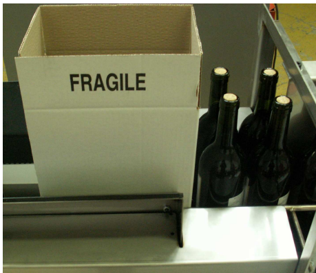
3. En automatique : Fermeture des rabats inférieurs
