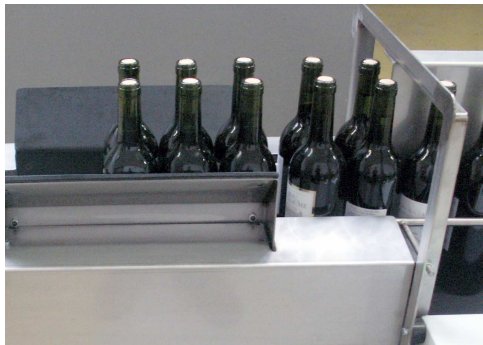
1. En automatique : Séparation produit - formation du lot
