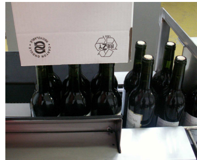
2. Manuellement : Mise en place du carton autour du lot
