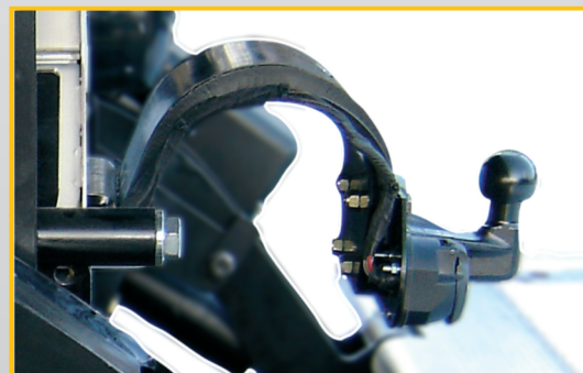
Option : Console attache-remorque, montage rapide et facile, y compris après la pose du hayon.
