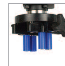
Plateau de préhension supérieur ajustable ouverture 10 - 78mm (utilisation avec les transducteurs 6 & 10N uniquement)
