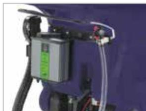
**Niveau du réservoir de solution** et tuyau de vidange
