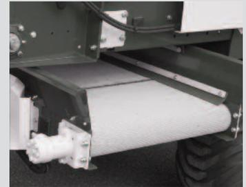
Tapis alvéolés caoutchouc dégratable, entraînement par rouleau et moteur hydraulique
