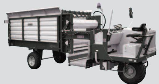
Tapis et Disques coulissants hydrauliques, distribution droite, gauche et paillage à disques.
