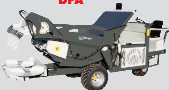
PAILLEUSE COMPACTE A DISQUES 1.50m de large, balles rondes et rectangulaires.
