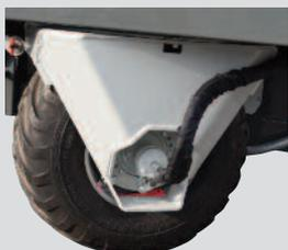
Roue directrice motrice avec moto-réducteur à entraînement direct (pas de chaîne ni de pignons). Une roue motrice avec moto-réducteur a autant de couple que 3 roues motrices Poclairin.
