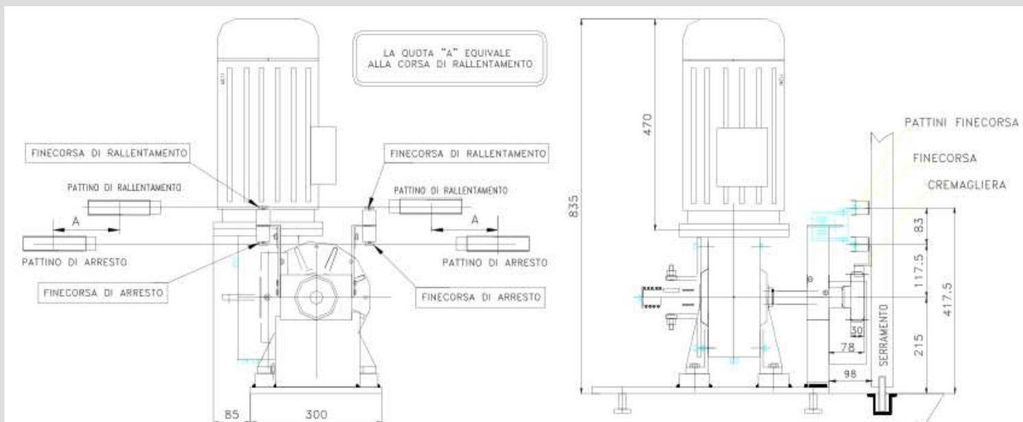
*N.B. : cet opérateur étant adapté aux installations de dimensions et de poids très élevés, il est dépourvu de limiteur de couple. C'est pourquoi, l'installateur devra équiper l'installation des dispositifs de sécurité permettant de respecter les normes en vigueur.*
